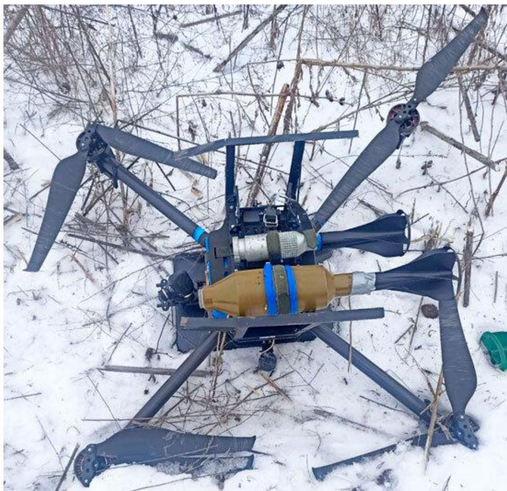
Дрон «Баба Яга» беспилотник с прикрепленными самодельными авиабомбами с хвостиками, напечатанными на 3D принтере [108]
